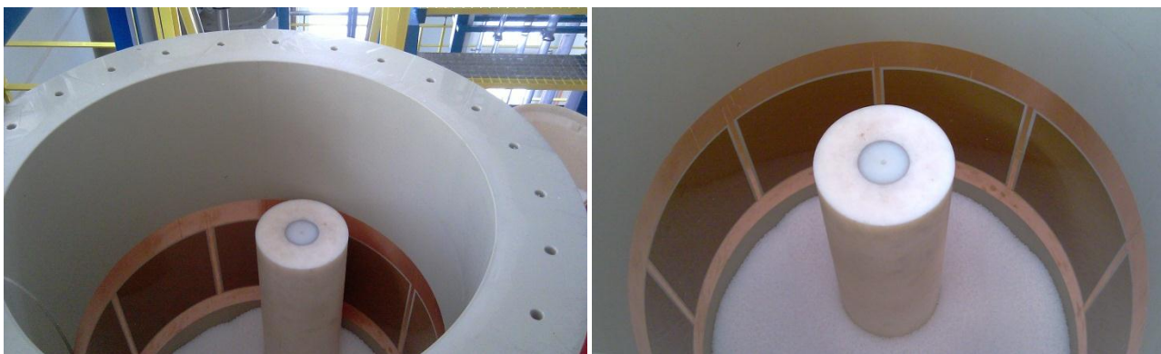
Rysunek 30. Przykładowe położenia jednorodnego obiektu w obszarze pomiarowy (w odległości 3 i 14 cm od elektrod),
