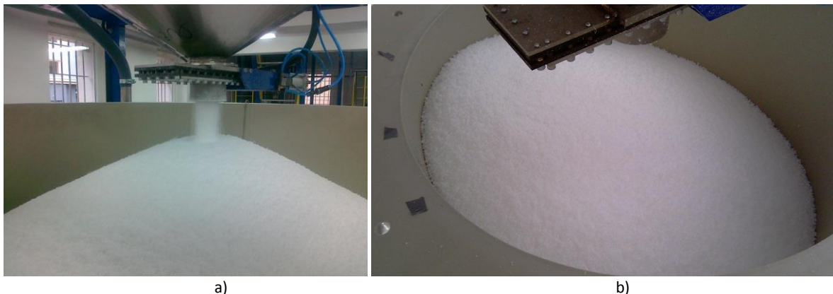
Rysunek 33. Metoda napełniania silosu przy luźnym (a) oraz gęstym (b) upakowaniu początkowym
