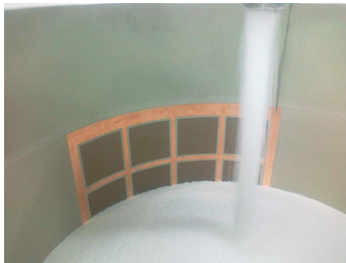
Rysunek. Zasypywanie przy pomocy lejki silosu krepiego.
