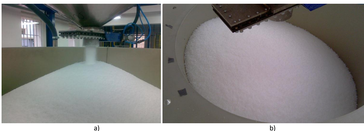
Rysunek 33. Metoda napełniania silosu przy luźnym (a) oraz gęstym (b) upakowaniu początkowym
