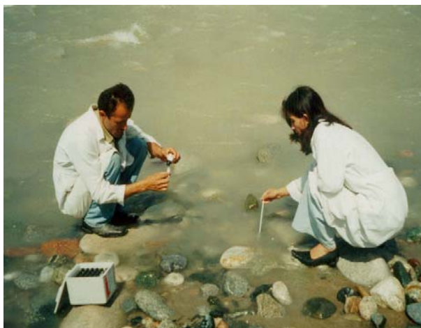
Фото 5. Определение температуры и растворенного кислорода (анализ 1-го дня).
